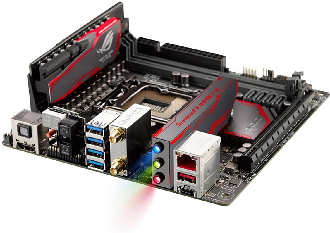
「MAXIMUS VIII IMPACT」は、R.O.G.ブランドを冠する Mini-ITX マザーボード“Impact”シリーズで Z170 チップセット搭載した最新モデルで Skylake CPU に対応します。別基板でデジタル制御の 10 フェーズの電源回路を搭載する基板型電源回路の採用しマザーボードに垂直に装着、同様に別基板のオーディオ回路「SupremeFX Impact III」による高音質サウンド機能を備え、ヘッドフォンのインピーダンスを自動的に検出して最適化。最大 600Ωのインピー
